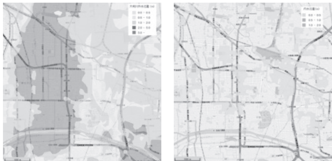
図3 平野区域の大和川外水氾濫と大雨などによる内水氾濫の浸水深想定図(国土交通省近畿地方整備局資料をもとに作成)
