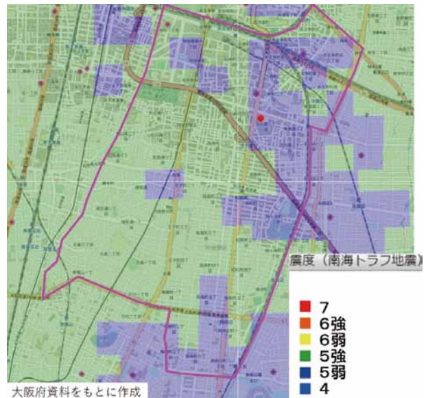
図6 南海トラフ地震での想定震度
