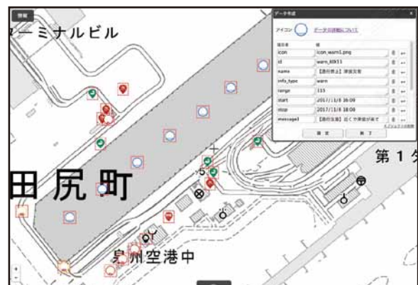
図8 「CERC-AR」のデータ作成用Webシステム
