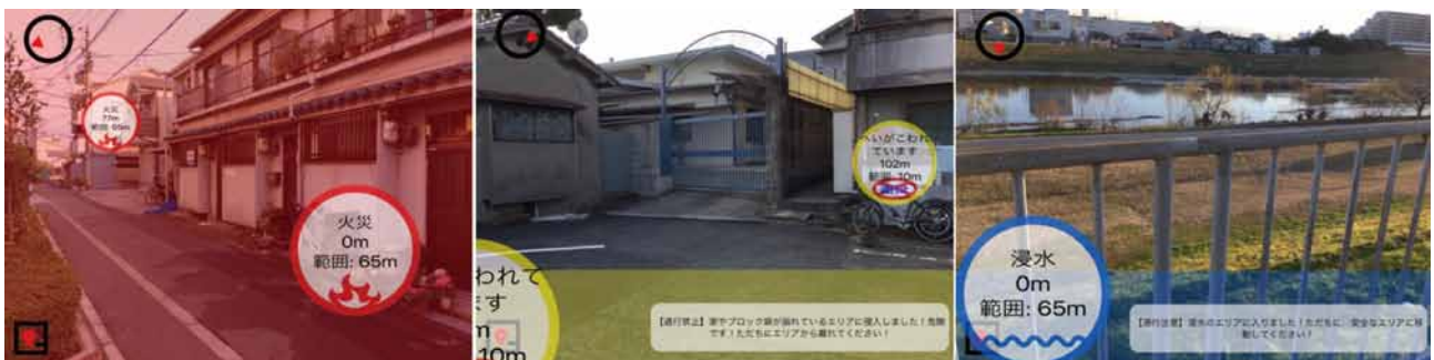
図1 災害範囲に侵入した際のアプリ画面(火災は赤色、道路閉塞は黄色、浸水は青色に変化)
