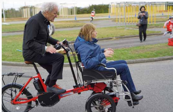
移動困難者を想定した大人2人乗り電動アシスト三輪車の試乗実験
